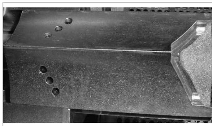
Рис. 6: CR золотник для CSH85 с портом ECO. У компрессоров CSW и CSH.6 в золотнике отсутствует ECO порт; вместо этого он встроен непосредственно в корпус.
